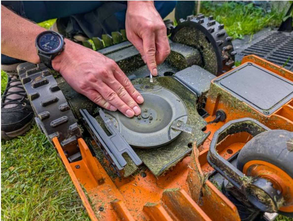
Wechsel der Messer beim Worx Landroid Vision M800.
